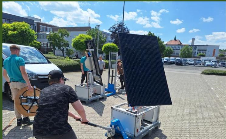
Inbetriebnahme der nachgesteuerten Photovoltaik-Anlage
